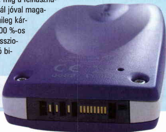
A T65-ös akkumulátora a különleges csavarral rögzített hátlap mögött rejtőzik.
